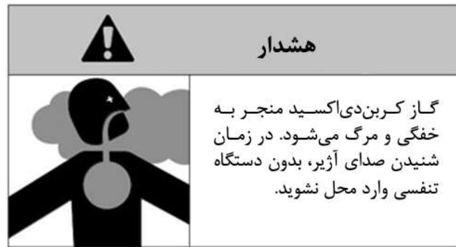
شکل ۲۱- علائم ایمنی در ورودی محل های حفاظت شده با سامانه اطفاء حریق کربن دی اکسید
