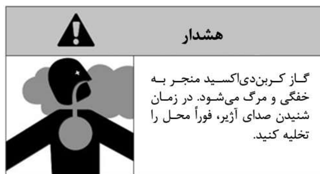
شکل ۲۰- علائم ایمنی در محل‌های حفاظت‌شده با سامانه اطفاء حریق کربن‌دی‌اکسید
