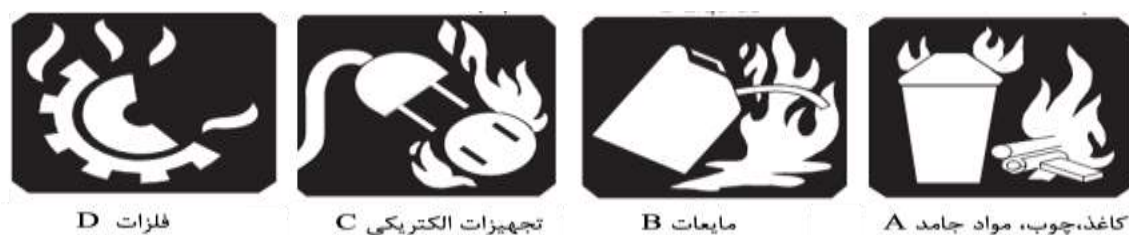
شکل ۱- نشانه‌گذاری رده‌های مختلف حریق
