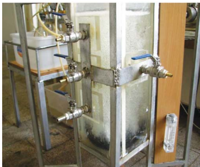
بیوراکتور غشایی غوطه ور مورد استفاده در آزمایش دوم، (۱) تانک بیوراکتور، (۲) توزیع کننده هوا، (۳) ماژول غشایی، (۴) مقاومت نوری
