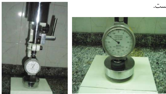
شکل ۸) دستگاه سختی‌سنج Shore D
